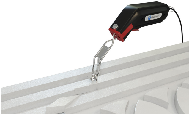
EPS solumuovilevyn uritus LK Lämpöleikkurilla 90 W.
